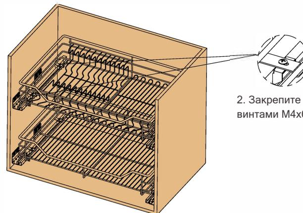
2. Закрепите корзины на направляющих винтами M4x6 согласно рисунку.
